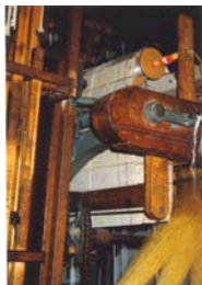
Die Lochkartensteuerung der Jacquard-Maschine
